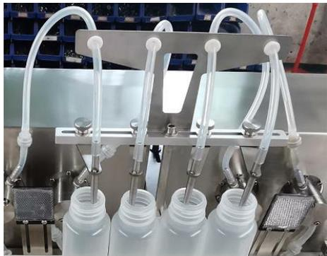
隐藏型灌装头升降装置，灌装头可伸入瓶内灌装减少泡沫产生和避免物料溢出
