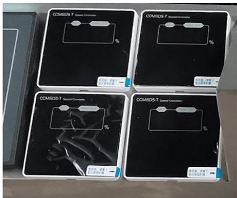
各泵二级速度独立调节，实现双速度灌装，防起泡和液体溢出的同时，提高灌装的精度
