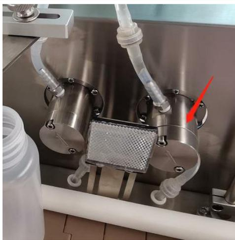
标配自吸式磁力齿轮泵，计量准确；其它计量泵比如蠕动泵可以选配。
